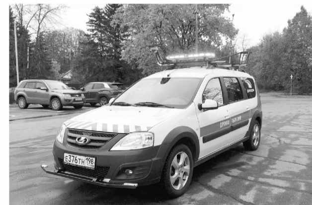
► Комплекс дорожной лаборатории – оснащённый камерой и специальными датчиками автомобиль
